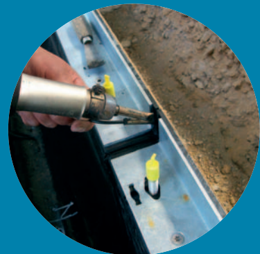
Besondere Herausforderung an die Produktion: Entwässerungsrinnen mit speziell angefertigten elektrisch leitfähigem PEHD
