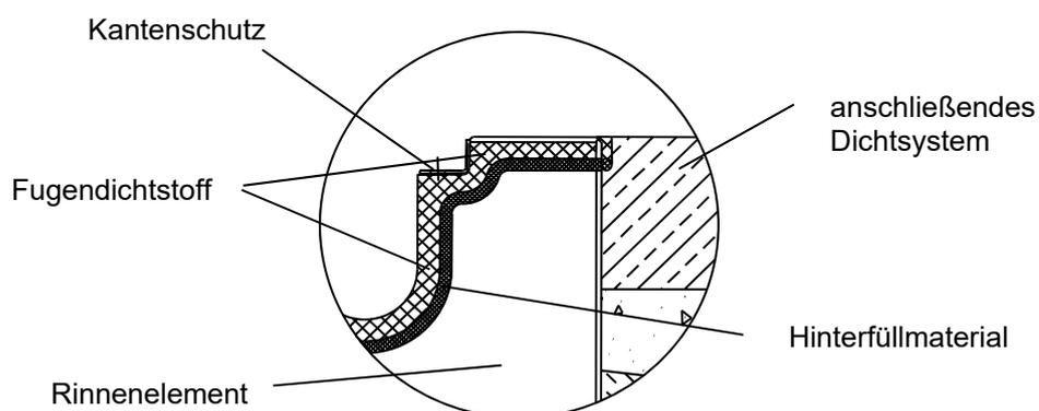
**Fugendimensionierung** zwischen den Rinnenfertigteilen und zwischen der anschließenden Dichtkonstruktion und den Rinnenfertigteilen ohne Oberflächenschutz aus feuerverzinktem Stahl
