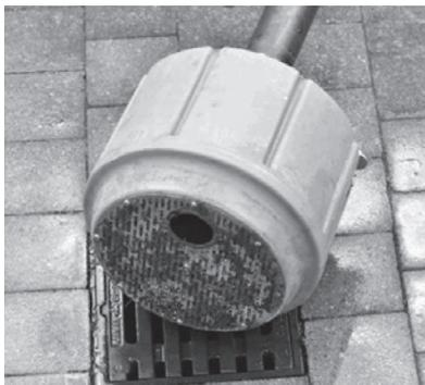
1. Filterelement über den Abfluss legen.
