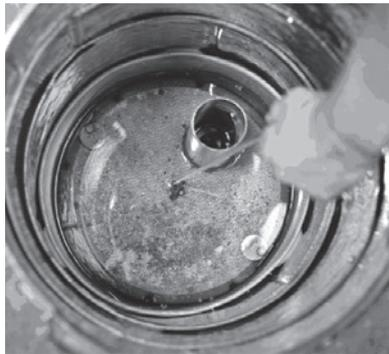
5. Den Haken des Werkzeugs in die mittlere Öse des Filters einhaken.
