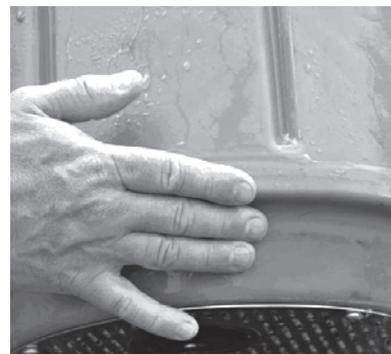
6. Mit der Hand kontrollieren, dass keine Verunreinigungen auf der Kante zurückbleiben.
