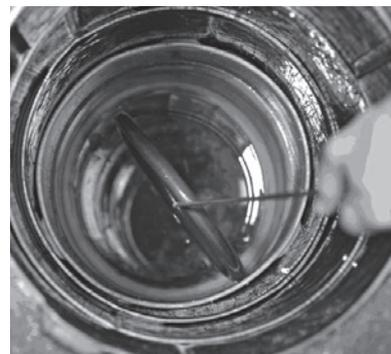
3. Gummidichtung mit dem Werkzeug herausholen.
