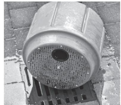
3. Die Unterseite des Filterelements muss komplett sauber sein.
