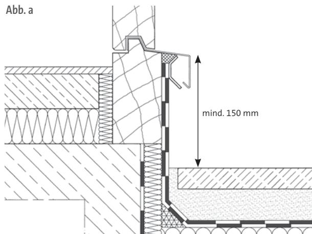
Abbildung a. zeigt den vorgeschriebenen Übergang von drinnen nach draußen ohne Entwässerungsrinnen. Der Absatz stellt in der Regel eine Nutzungseinschränkung, auf jeden Fall aber ein erhöhtes Unfallrisiko dar.
