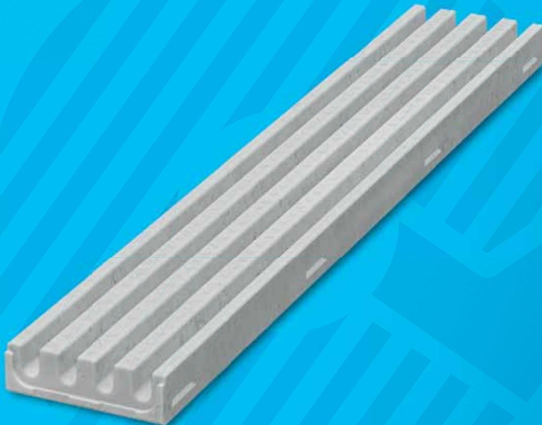
Elegant, leise und effizient – so sollten Parkhäuser und Tiefgaragen entwässert werden. All das und noch einiges mehr bietet die BIRCOparksafe®. Durch die monolithische Bauweise und das ebene Querprofil werden störende Klappergeräusche bei Überfahung der Entwässerungslösung verhindert. Die geringe Bauhöhe ermöglicht einen schnellen Einbau, die offene Bauform lässt sich perfekt reinigen.
