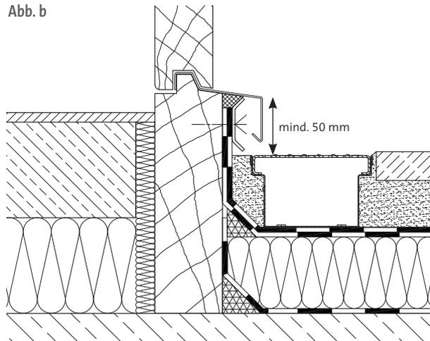
Abbildung b. zeigt, dass eine Verringerung der Anschlusshöhe auf min. 50 mm möglich ist, sofern – bedingt durch die örtlichen Gegebenheiten – zu jeder Zeit ein einwandfreier Wasserablauf im Tür-/Fensterbereich sichergestellt ist und um Anpassungen am Einsatz der Entwässerungsrinne vornehmen zu können. Ist kein ausreichender Schutz vor Spritzwasser durch eine Überdachung oder Vordach gegeben, sollten Entwässerungsrinnen mit einer Breite von min. 150 mm verwendet werden.
