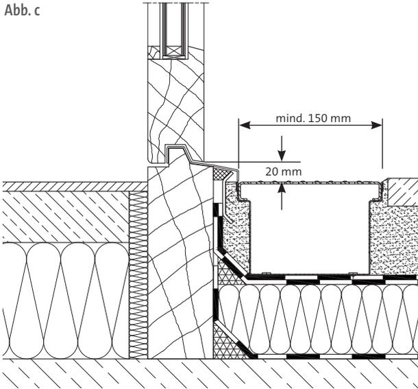
Abbildung c: Barrierefreie Zugangs- und Eingangsbereiche sind gegeben, wenn diese schwellenlos zu erreichen sind. Sofern es technisch unabdingbar ist, dürfen sie jedoch nicht höher als 20 mm ausgeführt werden.
