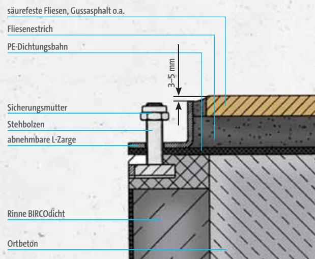
Alternativ kann die PE-Dichtungsbahn auch bauseits an die PEHD-Leiste angeschweißt werden.
