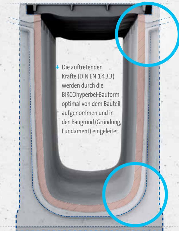
+ Die auftretenden Kräfte (DIN EN 1433) werden durch die BIRCOhyperbel-Bauform optimal von dem Bauteil aufgenommen und in den Baugrund (Gründung, Fundament) eingeleitet.
