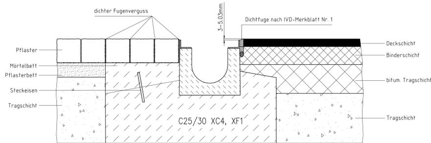
aufgebaut nach RSTO mit setzungsfreien, frostsicheren Tragschichten
