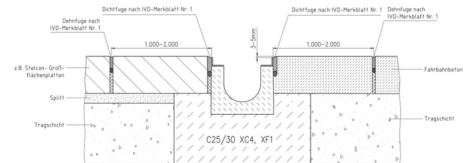
aufgebaut nach RSTO mit setzungsfreien, frostsicheren Tragschichten
