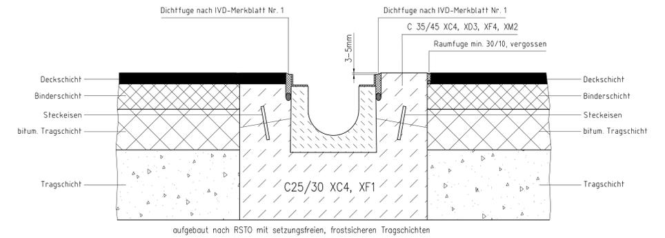
aufgebaut nach RSTO mit setzungsfreien, frostsicheren Tragschichten
