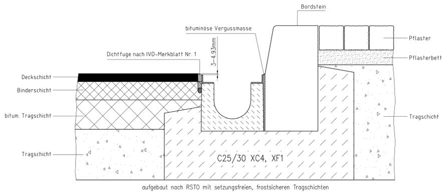
aufgebaut nach RSTO mit setzungsfreien, frostsicheren Tragschichten
